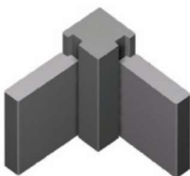
2 regatas descentradas alineadas a cara del pilar
